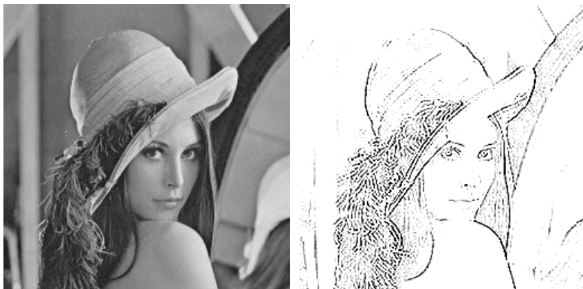
Joonis 7. Originaalpilt ning Laplace'i operaatori rakendamisel saadud pilt. Kasutatud tekstis toodud 7 \times 7 maatriksit, seejärel negatiivpilt
