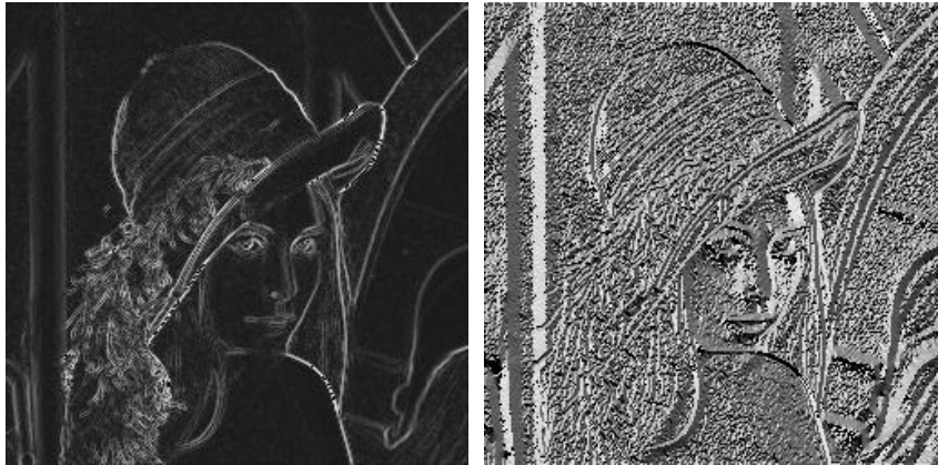
Joonis 4. Gradiendi pikkuse ning sihiga teisendatud pilt. Pildid on genereeritud programmiga ImageJ , kasutades vastavat pluginat
