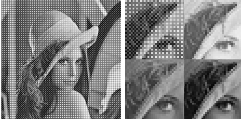
Joonis 2. Bayeri valgusfiltrite tekitatud RAW- pilt. Kõrval 4\times suurendatud detail ning R , G ja B kanalid
