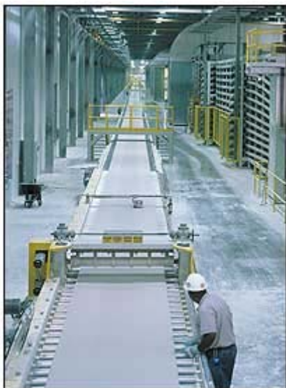
Joonis 1.11 Kipsplaatide liin
