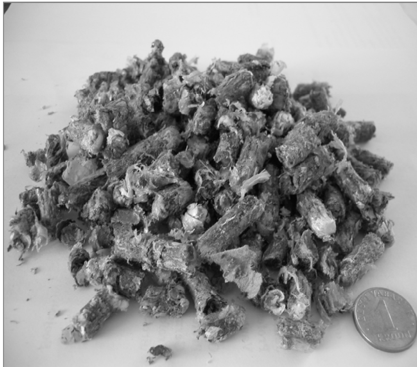
Joonis 10.1. Granuleeritud jäätmekütus (jäätmegraanulid) Q_a^t = 6,82 MWh/t, W^t = 5,4\% W^t = 5,4\% , A^k = 5,7\% , C^k = 58,2\% , H^k = 8,36\% , N^k = 0,23\% , S^k = 0,18\%
